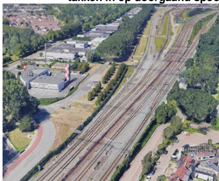
Figuur 2.9 Goederensporen vanaf uitgang Kijfhoek takken in op doorgaand spoor
